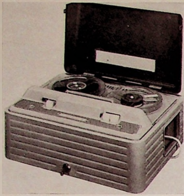
Bild 1 (oben). „EL 6922“, einer der ersten speziell für das Abspielen funktioneller Musik konstruierten Abspielautomaten
